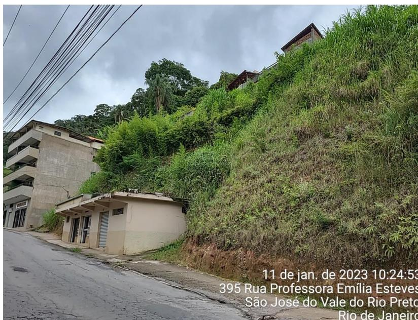
**Figura 15: Via sem Dispositivos de Drenagem Urbana e de Contenção de Encostas**
